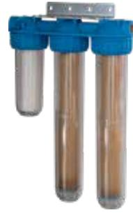
Die Nachspeisekapazität wird über die PICOCONTROL-/MULTICONTROL-/TOPCONTROL-Elektronik laufend überwacht und der Betreiber bei erschöpfter Kapazität der Enthärtungskartusche zu deren Austausch aufgefordert. Vor Erschöpfung der Restkapazität erhält der Betreiber eine Information zum Tausch der Kartusche (Warnmeldung). Erfolgt kein Austausch der Kartusche wird die Nachspeisung gesperrt. Dadurch wird sichergestellt, dass kein unzulässiges Ergänzungswasser nachgespeist werden kann (Störmeldung).
