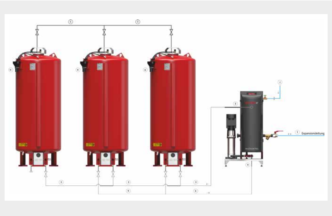
Abbildung: hydraulisches Schema MCM-M2 + 2x EG-M + EGZ-M + MCF, ohne Entgasung, mit Vorschaltgefäß
