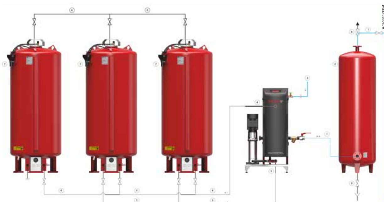
Abbildung: hydraulisches Schema MCM-M2 + 2x EG-M + EGZ-M + MCF, ohne Entgasung, mit Vorschaltgefäß
